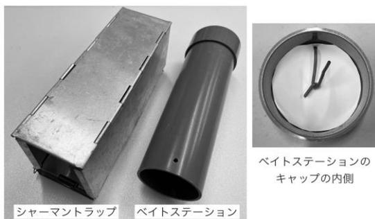
図 2. 本研究で用いたシャーマントラップとベイトステーション。ベイトステーションのキャップの内側の構造(レの字のフック)を右に示した。
