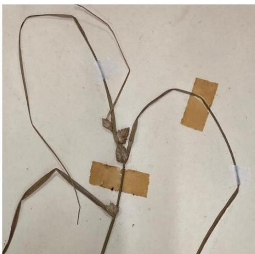
図 2. 経年劣化で褐変した透明粘着テープの例
