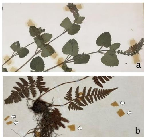
図 3. 経年劣化で透明粘着テープの粘着剤が台紙を着色した例
