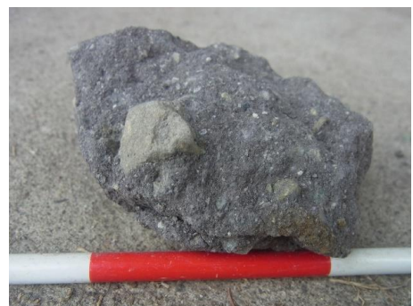
図18 <八女>弱WT 含まれる軽石多く多く 凝灰質 茶色を帯びる 軽い 内田川川床
