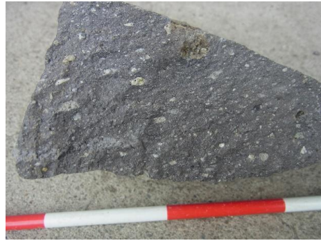
図15 <八女>強WT 肥猪のタイプ1と似るがマトリックスが茶色を帯び凝灰質 長山
