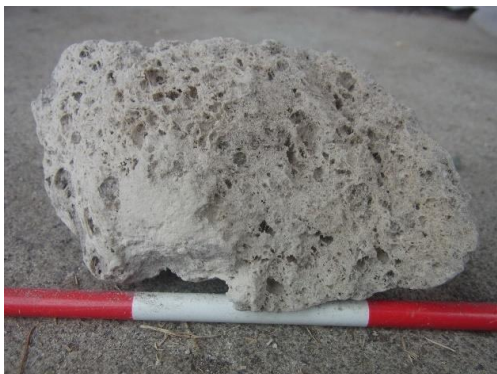
図7 <小谷>白色～黄白色 発泡が良い 丸い穴 小さくて黒い粒は角閃石 軽い 迎町
