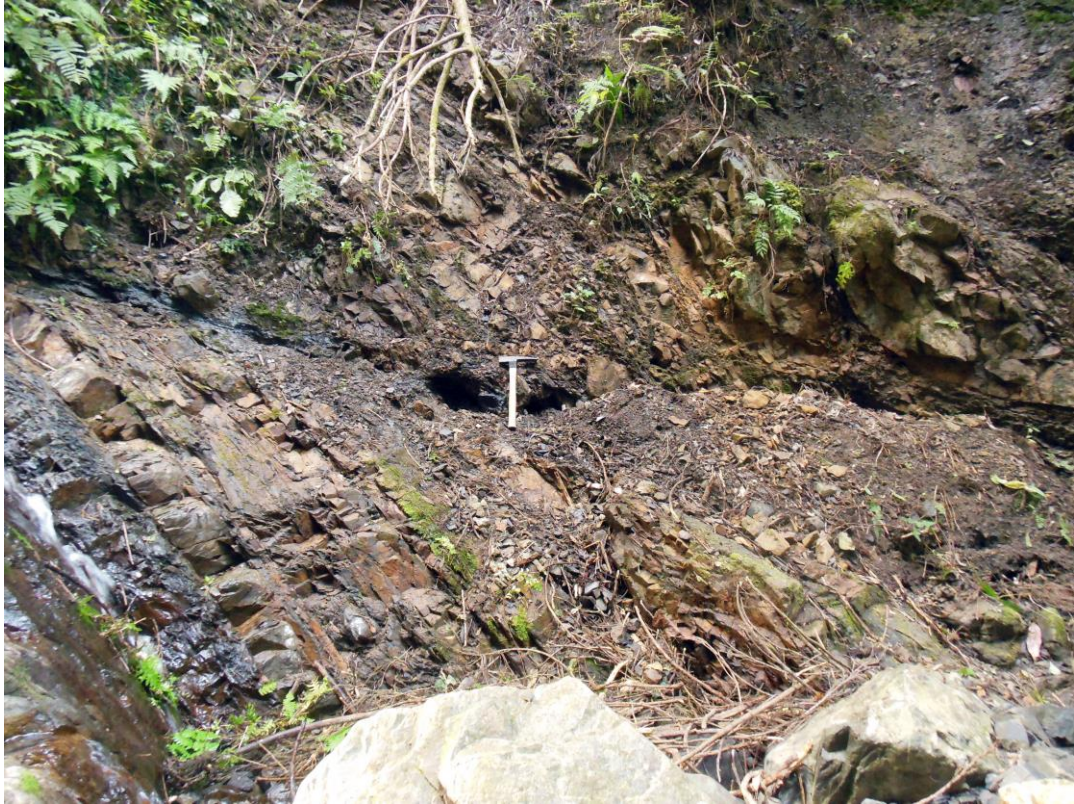
図8 露頭での低角度破碎帯(走向傾斜は約 N72°E,18N)
