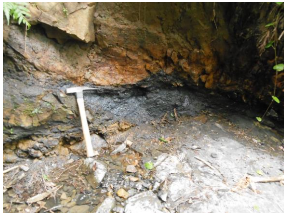
図9 濃藍色～暗黒灰色の断層ガウジ
