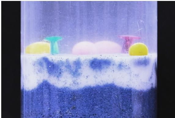
図26 実験の結果,形成された液状化
